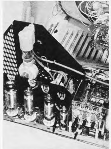
Links: Bild 3. Burggraf Color 1045 mit zwölf Röhren, 41 Transistoren, 45 Dioden und vier Gleichrichtern (Werkaufnahme: Graetz)
