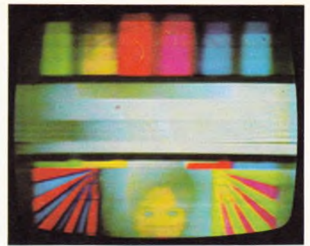
Bild F 16. Farbtestbild nach Bild F 7b ohne Leuchtdichteanteil
