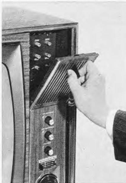
Bild 5. Die Konvergenzplatte steckt hinter dem abnehmbaren Hochtonlautsprecher (Werkaufnahme: Grundig)
