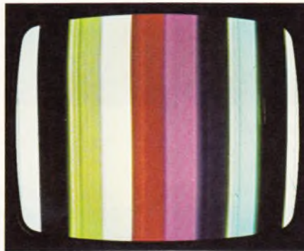
Bild F 18 Phasenbalkentestbild mit Überschwüngen durch Reflexionen bei nicht abgeschlossener Verzögerungsleitung
