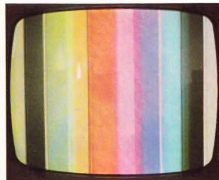
Bild F 12. Farbbalkentestbild mit unverzögertem Leuchtdichtesignal. Leuchtdichtesignal- und Farbdifferenzsignalbild decken sich nicht mehr
