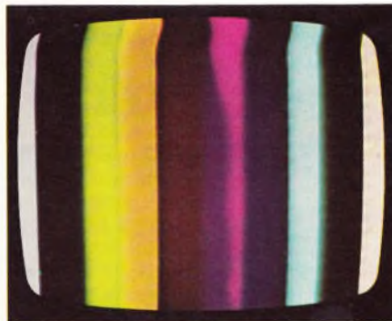
Bild F 9. Phasenbalkentestbild bei Übersteuerung des Zf-Verstärkers
