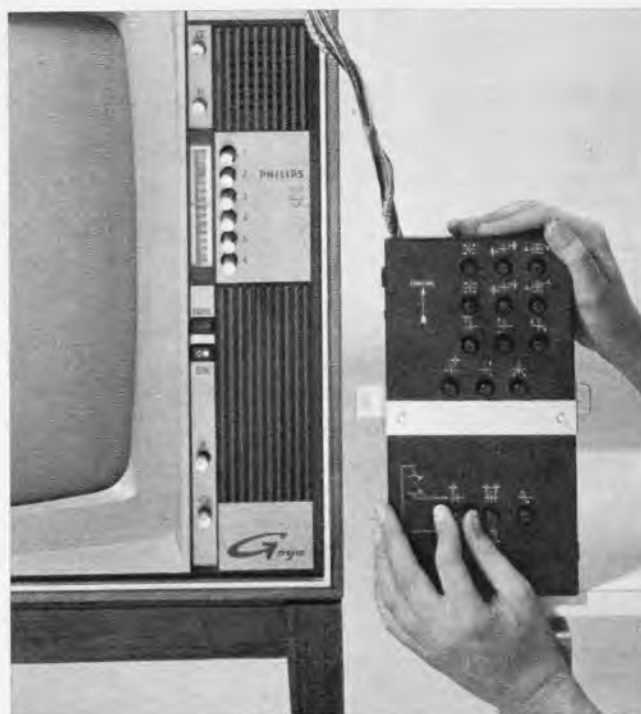
Bild 9. Konvergenzeinheit zum Einstellen der Trimmwiderstände, aus dem Gehäuse herausgenommen
