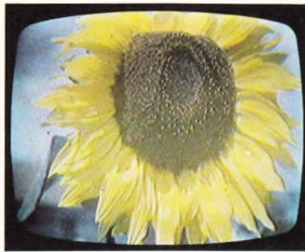
Bild F 15. Farbbild bei zu großer Helligkeit, es tritt eine Entsättigung der Farben ein
