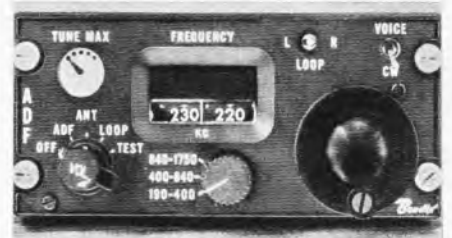
Bild 8. Das Bedienungsgerät zum Bendix-Radiokompaß DAF-73 (Bereich 190 kHz bis 1900 kHz) Foto: Telefunken
