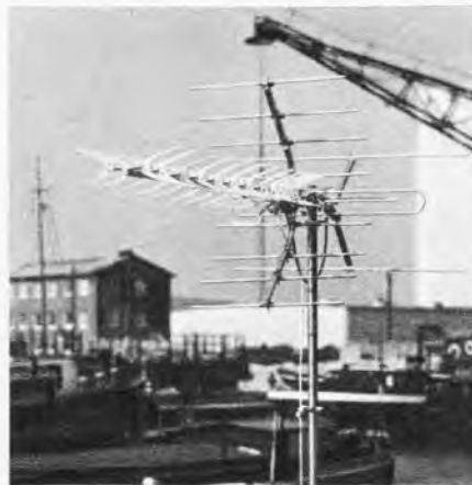
Bild 1. Fernseh-Kombinationsantenne UC 67 von Fuba, montiert auf einem Binnenschiff
