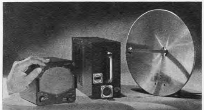
Bild 11. Viele Flugzeuge tragen bereits eigene Wetter-Radargeräte. Hier eine besonders kleine Ausführung für Geschäftsreise- und Privatmaschinen Foto: Bendix
