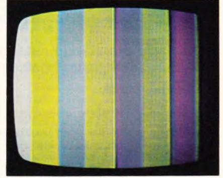
Bild F 24. Farbbalkentestbild bei übersteuertem Farbdifferenzsignalverstärker infolge falscher Arbeitspunkteinstellung des Transistors T 301 der geregelten Farbverstärkerstufe
