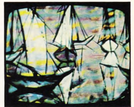
Bild F 29. Farbbild nach Bild F 20 mit „durchlaufender Farbe“ bei Ausfall der Referenzträgersynchronisation, Einsteller des Farbschalters auf Linksanschlag
