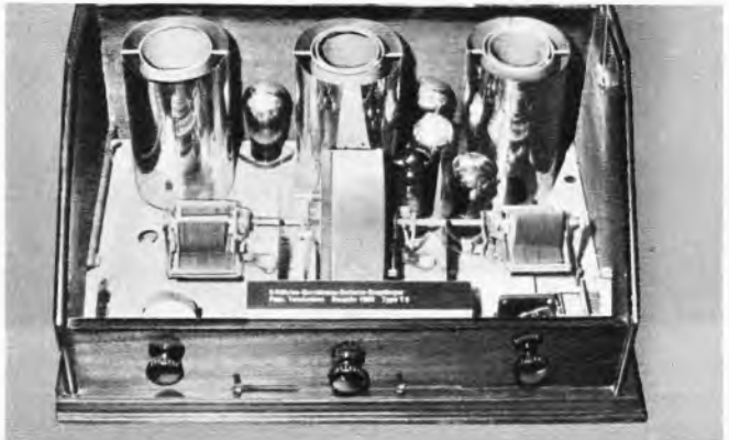
Bild 3. Zweikreis-Geradeempfänger mit großen, kupferabgeschirmten Luftspulen, vollkommener Innenabschirmung des Gehäuses und präzisen Drehkondensatoren von Telefunken (Baujahr 1928)
