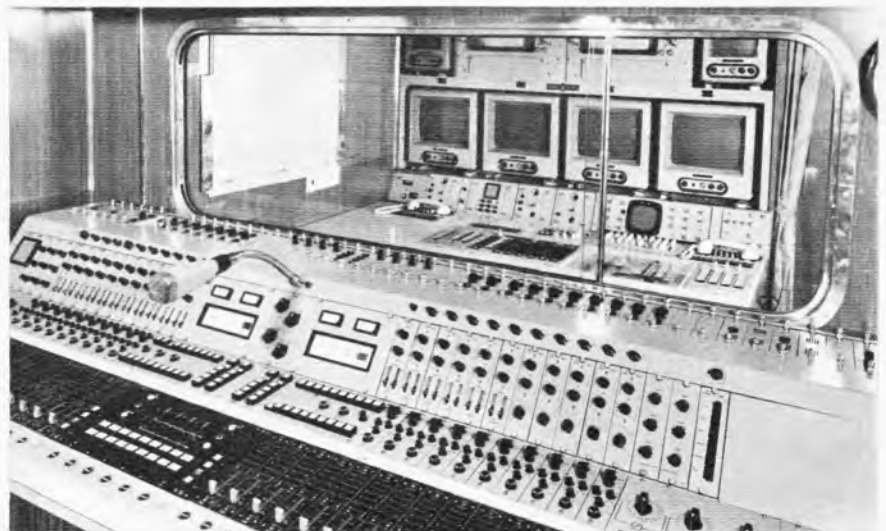
Bild 1. Tonregie des Farbfernseh-Übertragungswagens des Norddeutschen Rundfunks mit Durchblick zur Bildregie. Werkbild: Fernseh GmbH
