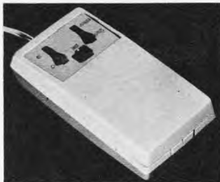
Einfaches Audiometer zum Prüfen der menschlichen Hörempfindlichkeit
