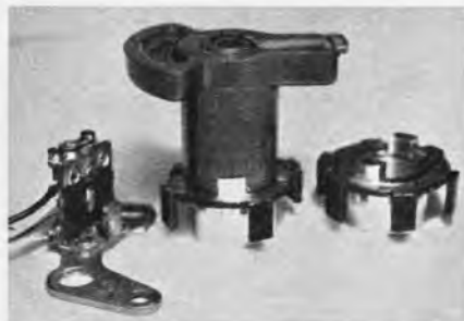
Bild 7. Lichtschranke (links) und Sektorenblenden für Vier- und Sechszylindermotor (Mitte und rechts)
