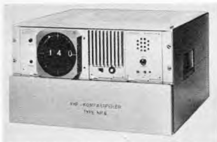
Bild 1. Für Peiler neuartig ist die unmittelbare Anzeige des Zielkurses (QDM) mit Hilfe von Ziffernröhren. Die Peilgenauigkeit wird mit \pm 1^\circ angegeben.
