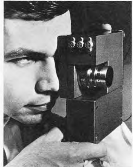
Bild 1. Neuartige Fernsehkamera ohne Bildröhre mit angebaute UHF-Kleinstsender, Gewicht 460 g
