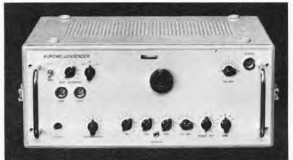
Rechts: Bild 1a. Der in ein Normgehäuse eingebaute Kurzwellensender macht einen industriemäßigen Eindruck. Mit dem linken unteren Knopf läßt sich der Trägerzusatz von außen einstellen
