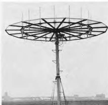
Bild 2. Die Antennenanlage NA 801 für den Kompaktpeiler NP 8 besteht aus 16 Monopolen auf einer Bezugsfläche von 3,5 m Durchmesser.
