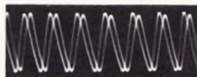
Bild 39. Oszillogramme der beiden übereinandergeschriebenen 4,43-MHz-Schwingungen mit 90^\circ -Phasenverschiebung am Eingang und am Ausgang des F_U -Kanals
