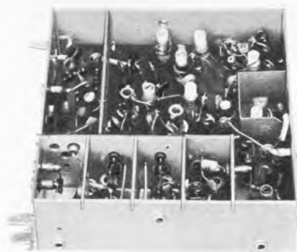
Baureihe 266 51 Kombinierter UHF-VHF-Tuner mit Diodenabstimmung und Diodenumschaltung
