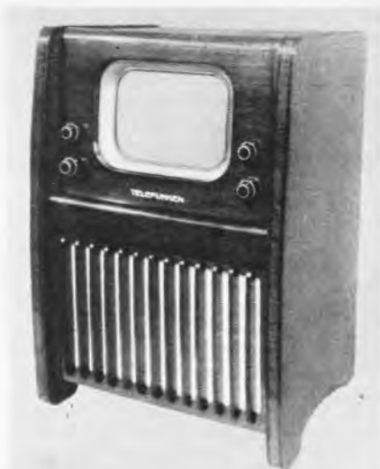
Der erste Fernsehempfänger aus dem Labor Bruch nach dem Krieg: Telefunken FE 8 mit 36-cm-Bildröhre, vorgeführt auf der Deutschen Industrieausstellung 1951 in Berlin
