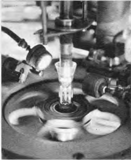
Bild 7. Einschmelzen des Dreifach-Elektronenstrahlstrahlsystems in den Kolbenhals. Dabei müssen die axiale Lage und der Abstand vom Schirm sehr genau eingehalten werden. Die Justierung auf der Einschmelzmaschine erfolgt mit Hilfe von zwei Sockelstiften, die von der Montage des Systems an als Bezugspunkte dienen (Werkaufnahme: Valvo)
