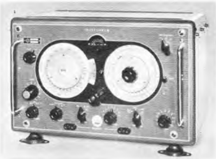
Goniometer-Peilanlage Telegon V mit neuem, schnellem und trägheitsarmen Nachlaufantriebssystem
