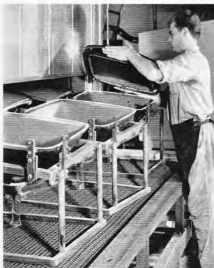
Bild 5. Die vakuumdichte Verbindung von Schirm und Konus erreicht man bei Farbblöhrren durch das Kleben mit einer Glasemaille, die als Paste auf den plangeschliffenen Konusrand aufgebracht wird. Mit einer genau bestimmten Neigung wandern die zu vereinigenden Teile durch einen Ofen mit an- und absteigendem Temperaturverlauf (Werkaufnahme: Valvo)
