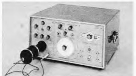
Bild 12. Dia-Testbildgeber mit Hf-Generator. Der schwarze Tubus links enthält die Projektionslampe für das Dia (Vertrieb: Metrimplex)
