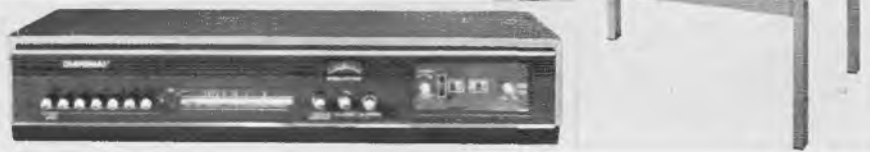
Bild 1. Links: Steuerteil des Imperial-Fernsehgerätes FST 430 mit eingebauter Schaltuhr. Rechts: Sichtteil, in Betrachterstellung aufgeklappt; nach hinten geschwenkt, bildet die dunkle Blendschutzscheibe eine Tischplatte
