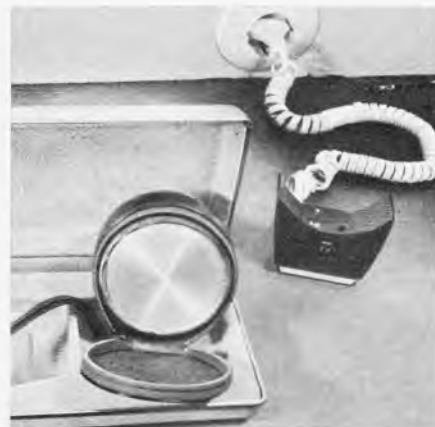
Bild 2. Mittelfrequenzempfänger IC 2000 mit integrierter Schaltung. Links das eigentliche Empfangsgerät, rechts der zugehörige Netzteil, auf den der Empfangsteil aufgesteckt werden kann (Foto: Schmahn)
