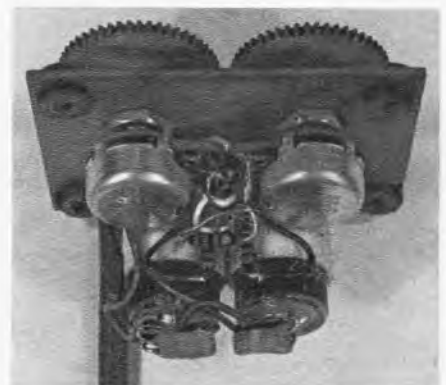
Bild 7. Aufbau der Rudermaschine mit Motoren, Getriebe, Stellungspotentiometer und Vorbinderständen
