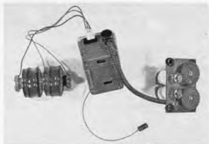
Bild 9. Empfangsanlage, bestehend aus Empfänger, Rudermaschine und Batterie
