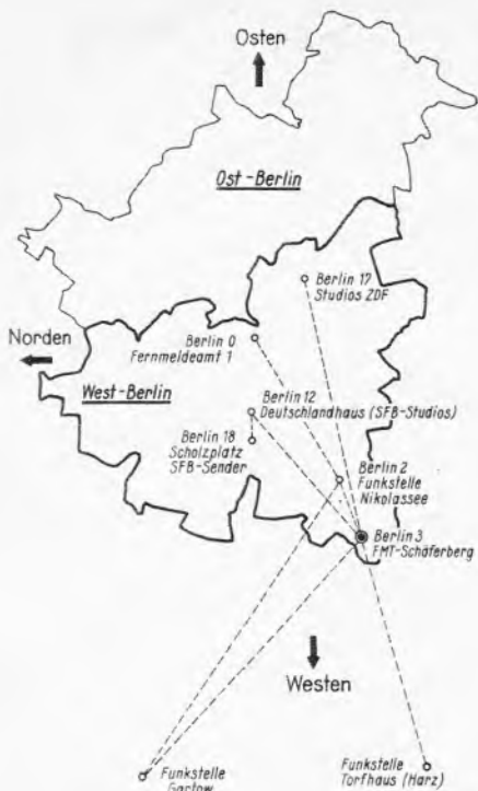
Bild 4. Richtfunkverbindungen innerhalb von West-Berlin und nach den Stationen Torfhaus, Harz und Gartow bei Dannenberg
