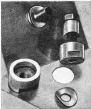
Hochwertiges Spezialwerkzeug zum Ausstanzen von Löchern für alle Materialien bis 1,5 mm Stärke geeignet. Sämtliche Größen v. 1—65 mm (je mm steigend) lieferbar.
