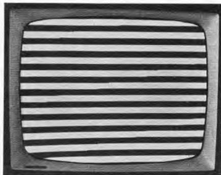
Bild 4. Waagerechte Balken zur Kontrolle der Bildlinearität (die an den Balken sichtbaren Einkerbungen sind Zeilenanfänge)
