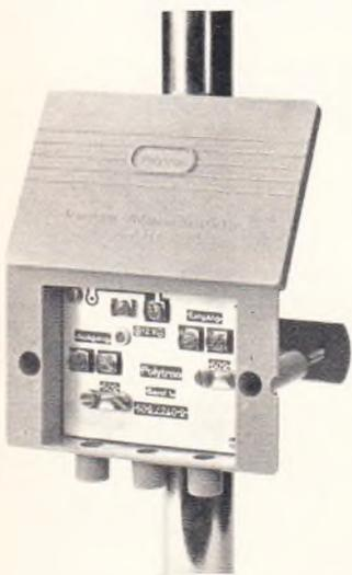
Aus- und Eingang 240 Ω symmetrisch oder 60 Ω koaxial, 2-Kammernsystem, allseitig geschirmt, Stromversorgung direkt an den Verstärker oder über das Antennenzuleitungskabel.
