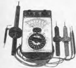
**Hansen Unimeter HM 16 T** Spitzeninstrument mit 20 000  $\Omega$ /V und allem Zubehör, wie 23-kV-Tastkopf, 1,4-kV-Tastkopf, HF-Tastkopf, Steckprüfspitze Meßbereich: 0-0,28 bis 700 V in 7 Bereichen.
