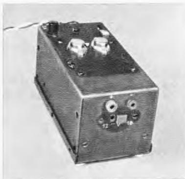
Bild 5. Die Abmessungen des vierseitig abgehobenen Aluminiumgehäuses sind  $150\text{ mm} \times 80\text{ mm} \times 75\text{ mm}$ . Die Oberfläche des Gehäuses und des Deckels (mit Gummifüßen) ist schwarz eloxiert.
