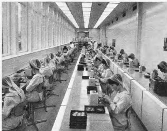
Bild 1. Vollklimatisierter Montageraum für die Bildröhrenfertigung (Werkaufnahme: SEL)
