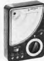
**MT-202 M-Vielfach-Meßinstrument** mit Spiegelskala und Überlastungsschutz; 20 000 Ω/V; 16 Meßbereiche; Gleichspannung: 0—5/25/50/250/500/2500 V; Wechselspannung: 0—10/50/100/500/1000 V; Gleichstrom: 0—50 µA/25 mA/250 mA; Widerstand: 0 bis 60 kΩ/0—6 MΩ, mit dB-Skala u. 2 Kapazitätsber.; einschl. Batterie, Meßschürren und Anleitung DM 39 50
