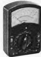
**MT-205 M-Vielfach-Meßinstrument** mit Spiegelskala und Überlastungsschutz; 20 000 Ω/V; 21 Meßbereiche; Gleichspannung: 0—0,6/30/120/600/1200/3000/6000 V; Wechselspannung: 0—6/30/120/600/1200 V; Gleichstrom: 0—60 µA/6 mA/60 mA/600 mA; Widerstand: 0—6/600 kΩ/6/60 MΩ
