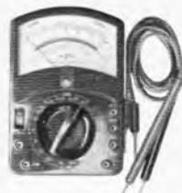
**CTR-Multitester VM 7** Dieses Meßinstrument hat einen Innenwiderstand von 50 000 Ω/V. Außerdem ist die Preiswürdigkeit des Gerätes wohl kaum zu unterbreiten, wenn man bedenkt, daß das Gerät mit einer Spiegelskala ausgerüstet ist. **Meßbereiche: Gleichspannung: 0-0,6-3-15-60-300-600-1200-3000 V, Wechselspannung: 0-6-30-120-600-1200 Ω/V, 1500 Ω/V**
