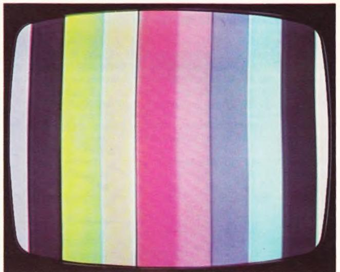
Bild F 52. Farbbalkentestbild bei zu niedriger Emission des Rot-Elektronenstrahlensystems
