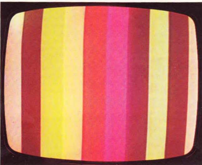
Bild F 51. Farbbalkentestbild bei zu hoher Emission des Rot-Elektronenstrahlensystems
