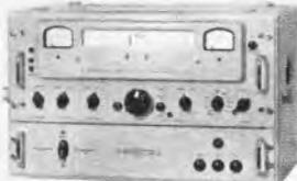
**Rohde & Schwarz Flugsicherungs-Empf. NE 1**, Frequenz: 100 bis 156 MHz variabel, 1. ZF 9,75 MHz, 2. ZF 1,65 MHz, Bandbreite 10 kHz, 14 Rö., Rauschsperrung, S-Meter, Instrument z. Rö.-Prüfung. **598.—**
