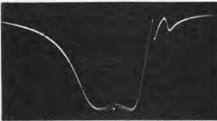
Bild 23. Durchlaßkurve mit eingeblendeter Frequenzmarke
