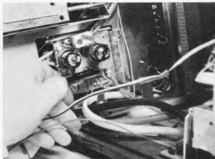
Bild 3.04-3 Anlegen eines Sperrschwingers (Minitest II) an den VHF-Kanalschalter
