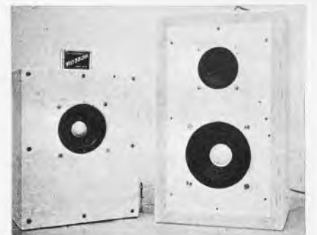
Bild 2. Laboraufbau der Box; links daneben eine 3,6-Liter-Box mit Doppelkonuslautsprecher
