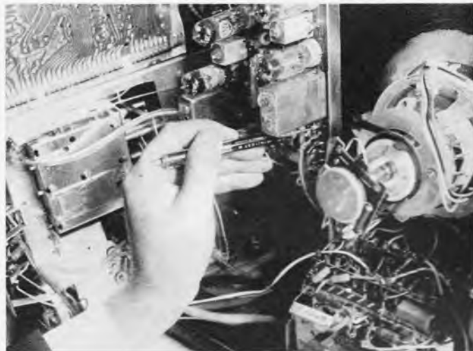
Bild 3.04-2. Anlegen eines Sperrschwingers (Minitest II) an den Zf-Verstärker
