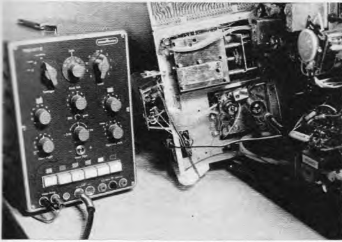
Bild 3.04-4. Anlegen des Zf-Signales aus dem Bildmustergenerator über eine Aufblaskappe in den Kanalschalter
