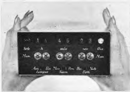
Applikationsmuster einer Digital-Uhr, aufgebaut aus 37 monolithischen Schaltungen (Werkaufnahme: SGS-Fairchild)
