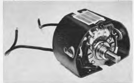
Bild 31b. Innenaufbau des Helligkeitseinstellers
