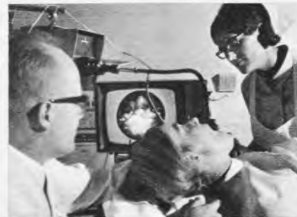
Direkte Farbfernseh-„Übertragung“ aus dem Magen mit einer Drei-Vidicon-Farbkamera und Glasfaseroptik (Werkaufnahme: Siemens)
