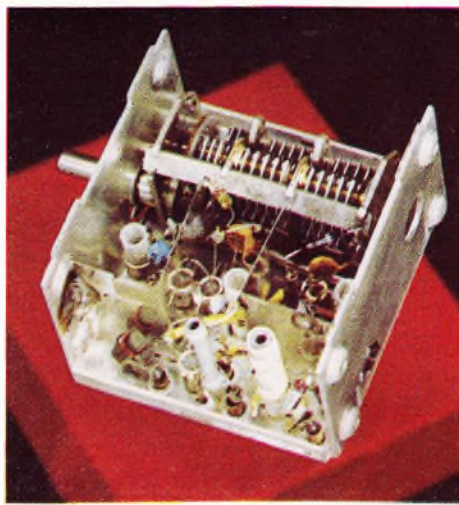
Bild 1: Dieses hochwertige Industrieerzeugnis – den volltransistorisierten UKW-Baustein Ihres Rundfunkgeräts – erhalten Sie vollkommen fertig aufgebaut, verdrahtet und vorabgeglichen.
