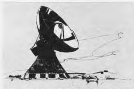
Bild 1. Skizze des zweiten Antennenspiegels der Bundespost-Satellitenempfangsstation Raisting (Durchmesser: 28,5 m)
