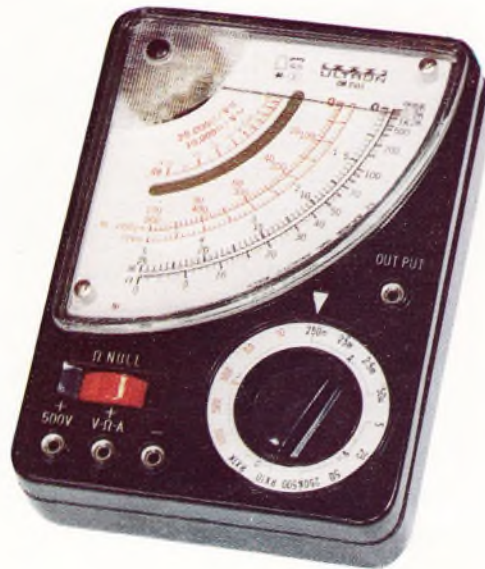
Bild 3: Dieses Vielfachmeßinstrument modernster Konstruktion gehört ebenfalls mit zur Ausrüstung des Elektronik-Labors. Wenn Sie schon etwas davon verstehen, beweisen Ihnen die folgenden Angaben seine Qualität:
