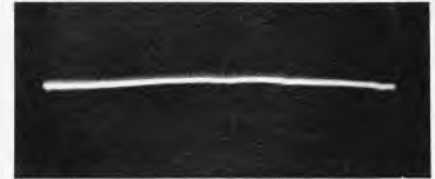
Bild 3.06-5. Fehlerhaftes Oszillogramm am Steuergitter der VHF-Mischröhre (nach Bild aufgelöst) mit leichter Brummstörung
