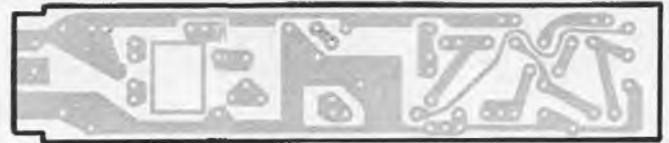
Bild 16. Die Leiterbahnordnung auf der Schicht-seite der Printplatte
