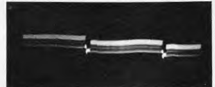
Bild 3.06-3. Oszillogramm am Steuergitter der VHF-Mischröhre (nach Bild aufgelöst)
