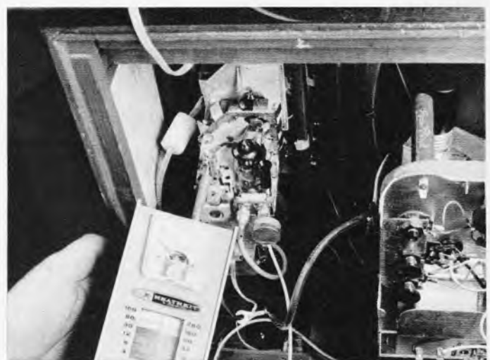
Bild 3.07-2. Oszillatorprüfung mit Tunneldipper
