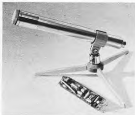
Bild 1. Das fertige Mikrofon auf einem Tischständer. Im Vordergrund eine bestückte Leiterplatte
