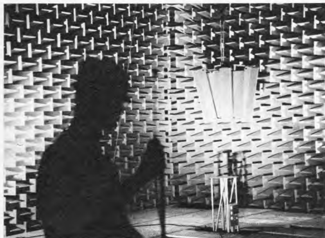
Links: Bild 1. Das Innere des schalltoten Raumes im Labor für technische Akustik der Siemens-Werke in Karlsruhe
