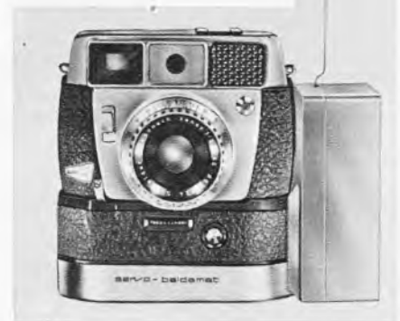
Baldomatic-Kleinbildkamera mit Automatik-Untersatz und angebautem Empfänger der Mecatron-Funkfernsteuer-einrichtung
