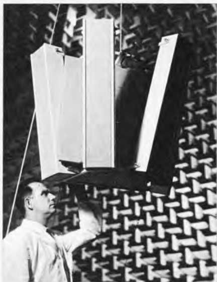
Bild 3. Lautsprecherkombination zur Beschallung von Sälen mit einem Volumen um 2000 m 3
