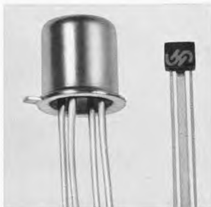
Bild 1. Größenvergleich zwischen dem Metalltransistorgehäuse TO-18 und einem Subminiatur-Kunststoffgehäuse (Werkaufnahmen: Siemens)
