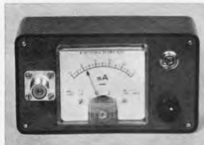
Bild 1. Außenansicht des Rauschgenerators (Werkaufnahme: Conrad)
