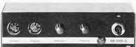
Thyristor-Vibrator mit fotoelektrischem Wandler und Transistorverstärker. Amplitudenregelung. Kein Abschalten des Vibrators erforderlich. Einstellbereich der VIB-Frequenz: ca. 2—15 Hz regelbar.
