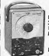
**HF-Meßsender TY-85**, 100 kHz bis 300 MHz in 7 Bereichen, Genauigkeit ± 1%, Anschl. 220 V~, Maße: 210 x 150 x 120 mm
