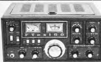
Empfängerverstimmung ± 6 kHz von Sendefrequenz möglich. Eingebautes Netzgerät 220 V und Spannungswandler für 12 V, Eichgenerator 100 kHz.
