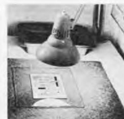
**Gedruckte Schaltungen** jetzt leichter und schneller selbst gemacht, durch **Foto-positiv-beschichtete Platten**. Nur Transparenzzeichnung auflegen, mit Glasplatte beschweren, belichten durch 100-W-Krypton-Birne, anschließend entwickeln und ätzen. Jeder Vorgang dauert nur wenige Minuten.
