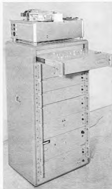
Bild 1. Außenansicht der gesamten elektronischen Zeitlupenanlage des IRT. Das Bedienfeld ist herausgezogen. Einen Eindruck von der guten Qualität einer Farb-Standaufnahme vermittelt unser Titelbild (Aufnahme: C. Stumpf)
