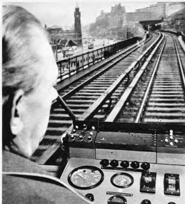
Das Fahrpult eines automatisierten Triebwagens der Hamburger Hochbahn AG mit vorgebautem Automatik-zusatz. Der Fahrer des „Geisterzuges“ bedient keine Hebel und Knöpfe mehr
