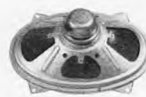
Typ P 1726, oval, Korb-φ 170 x 260 mm, 9 W, 4 Ω DM 12.70
