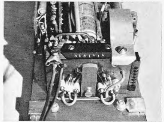
Bild 4. Teilansicht der Isolierplatte mit zwei Federsätzen
