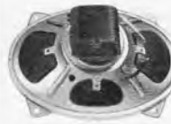
Typ P 1521*, oval, Korb-φ 150 x 210 mm, 8 W, 4 Ω DM 9.50
