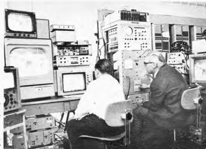
Bild 1. Der im Fernmeldetechnischen Zentralamt der Deutschen Bundespost entwickelte Secam/Pal-Transcoder während einer Farbübertragung aus Grenoble
