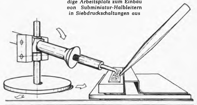
Bild 2. Anwärmen und Löten auf einer Mikroheizplatte
