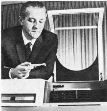
Bild 11. Ein Zugriffsarm ist aus dem Magnetplattenspeicher herausgenommen
