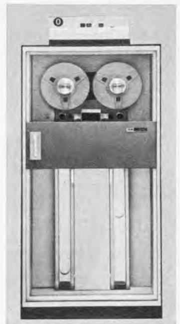
Bild 9. Magnetbandspeicher für die Rechentechnik. Man erkennt senkrecht nach unten verlaufend die Vakuumschleifenkästen
