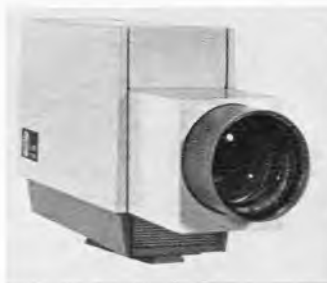
Bild 1. Farbfernseh-kamera für industrielle und medizinische Zwecke (VEB RFT-Studioteknik)
