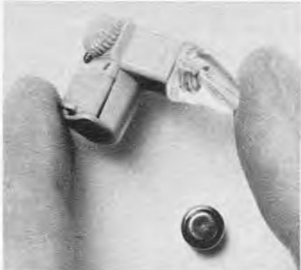
Das neue „Im-Ohr-Hörgerät“ mit integrierter Schaltung von Philips eignet sich für leichte bis mittlere Schwerhörigkeit. Das Ohrstück ist abnehmbar, so daß sich entweder Standard-Ohrstücke oder individuell angefertigte Ohrpaßstücke anschrauben lassen
