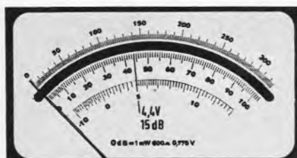
Bild 5. Der Spannung 4 V (Meßbereich 10 V nach Bild 3) entspricht der Spannungspegel p = + 15 dB
