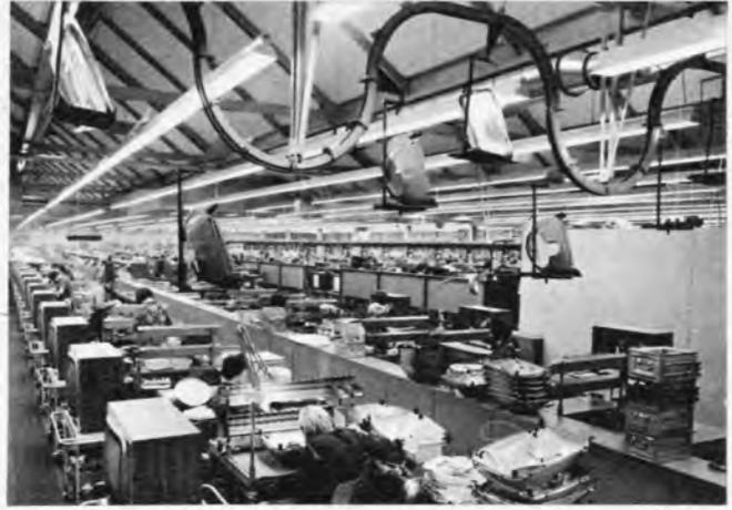
Endmontage mit Teileförderer in der Fertigung von Farbfernsehgeräten im Werk I, Hannover
