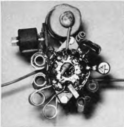
Bild 4. Untersicht des Bereichsschalters
