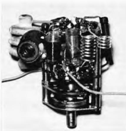
Bild 2. Der Bereichsschalter von der Spulenseite aus betrachtet
