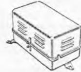
**Stahlblechgehäuse (Fabr. PFELFER)**, blankes, gezogenes Gehäuse mit Entlüftungskiefern, in Standard-Ausführung, bestehend aus Boden und Deckel. Nutzbarer Einbauraum: Grundfläche 280  $\times$  160 mm, Innenhöhe 130 mm, Materialstärke: Boden 1,4 mm, Deckel 0,8 mm ..... DM 7.90
