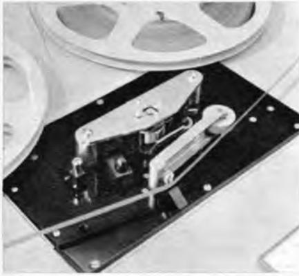
Links: Bild 3. Kopfträger der Muttermaschine mit Schmetterlingskopf (Aufnahmen 3 und 4: Magnetfilm-Technik Ing. A. Kurzeder)
