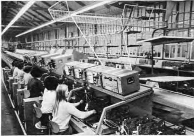
Dauerlauf und Endprüfung von Schwarzweiß-Fernsehgerätechassis im Werk I, Hannover
