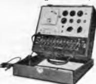
**KEW 119 Röhrenprüfgerät (TE 50)** im stabilen Holzkoffer noch praktischer! Das moderne, tragbare Röhrenprüfgerät für Service, Werkstatt und Amateure (Kathode, Emission-, Kurzschluß-, Heizfadenmessung). Zum Prüfen handelsüblicher Röhren. Im Deckel des Holzkoffers befindet sich eine Anleitung (engl. mit dtsh. Übersetzung). Röhrenmeßtabelle und Vergleichstabelle amer. Röhren. Maße: 220  $\times$  265  $\times$  105 mm
