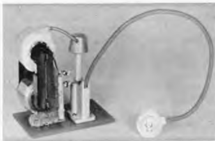
Hochspannungsgleichrichter vom Typ TV 18 S (18 kV), stehend neben einen Zeilentransformator montiert
