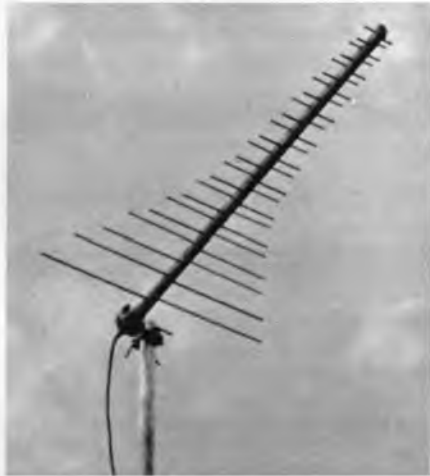
Bild 5. Extrem breitbandige Dipolantenne für den Frequenzbereich 165...1000 MHz
