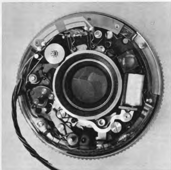
Bild 2. Elektronische Verschlusssteuerung von Prontor für die Vitessa 500 AE von Voigtländer
