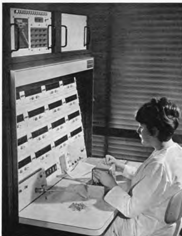
Bild 29. Ein Meßplatz für die elektrische Endprüfung von integrierten Schaltungen
