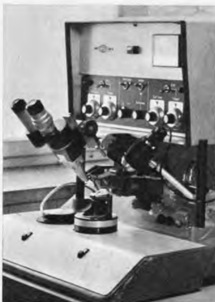
Bild 27a. Der Arbeitsplatz für die Ultraschall-Kontaktierung [6]
