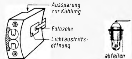
Bild 1. Die Anordnung der beiden Glühlämpchen
