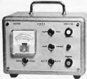
Bildröhren- Meß- Regenerator BMR 2 für Werkstatt und Altgeräte- Abteilung
