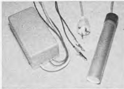
Bild 3. Das komplette Stroboskopblitzgerät. Rechts neben dem Netzteil mit eingebauter Triggerschaltung das handliche Blitzröhrengehäuse. Mit der vorderen Klemme werden die Impulse vom Zündkabel abgenommen. Dahinter die Masseklemme
