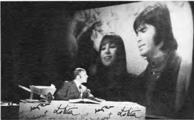
Oben: Bild 1. Background-Farbbildprojektion mit dem Simultan-Eidophor-Projektor bei der letzten Sendung „Musik aus Studio B“. Chris Howland im Vordergrund mußte hell angestrahlt werden, um ein gutes Bild mit der Studio-Farbkamera zu erzielen, dagegen durfte die Projektionswand nicht zu stark aufgehellt werden, um Kontrastverluste zu vermeiden [Aufnahme: NDR]
