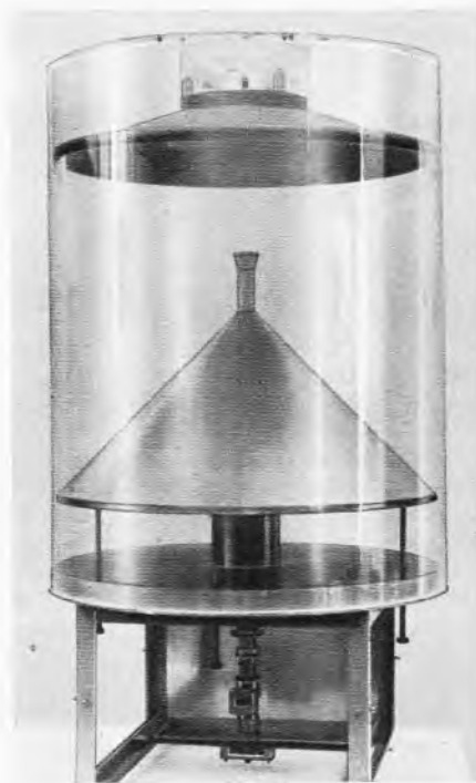
Bild 3. Rundstrahlantenne mit kreisförmiger Horizontalcharakteristik (Gewinn: 8...10 dB, Halbwertswinkel der Vertikalcharakteristik \approx 5^\circ )
