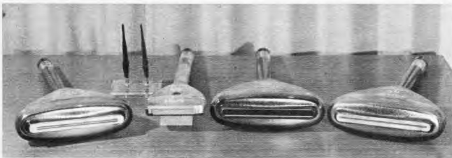
Oben: Bild 1. Die von Matsushita entwickelten Faksimileröhren. Von links: Glasfenster-Schreibröhre, Dünnschicht-Schreibröhre, Glasfaser-Schreib-/Leseröhre, elektrostatische Schreibröhre
