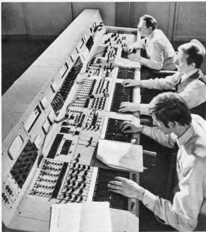
Sitral-Regiepult Modell 27 6 1 von Siemens für die Vertonung und Bearbeitung von Todd-AO-Filmen
