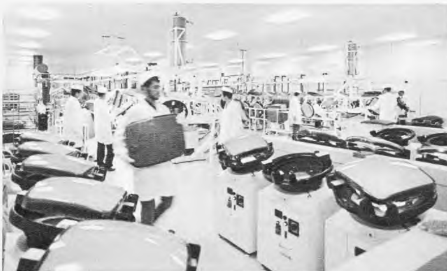
Bild 1. Vorn die Lichthäuser zur Belichtung der Bildschirme mit eingeknüpften Lochmasken, im Hintergrund die automatische Beschirmungsanlage
