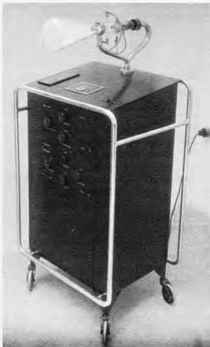
Elektronenstrahl-Oszillograf aus dem Jahre 1932, entwickelt von M. v. Ardenne, gebaut von Dipol AG, Arbon, Schweiz. In dem Gehäuse befinden sich Netzteil und Kippgerät (Foto: Manfred von Ardenne)
