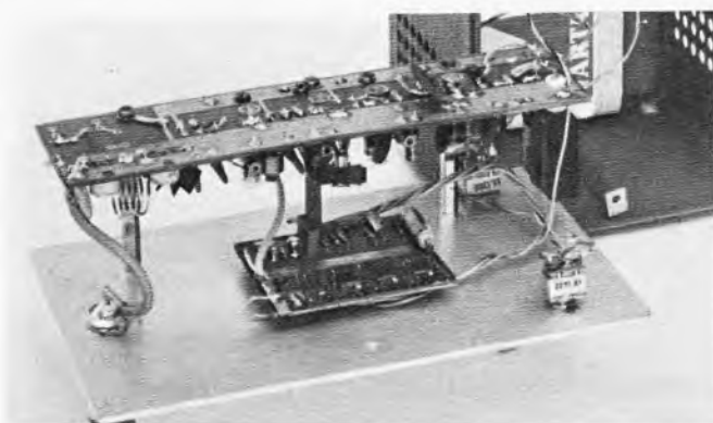
Beim Internationalen Bodenseetreffen des DARC in Konstanz fand dieser 2-m-Fuchsjagd-Sender viel Beachtung. Er ist mit einem Zeichengeber sowie integrierten Schaltungen bestückt und arbeitet mit tonloser oder tönender Telegrafie (Aufnahme: DJ A PO)
