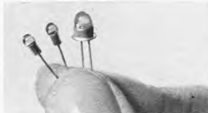
Links zwei der neuen Miniatur-Leuchtelemente mit sehr kleinem Halter (2,5 mm \phi ) im Vergleich zu konventionellen Elementen. Sie eignen sich als Signallampen in Geräten, für optoelektronische Anwendungen und für alpha-numerische Darstellungen an Digitalrechnern
