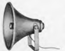
TC-15B Durchmesser 392 mm Leistung 15 Watt Widerstand 8 Ohm
