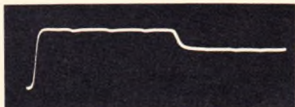
Bild 4a. Falscher Einbau einer Enddose anstelle einer Durchgangsdose in einer Gemeinschaftsantennen-Anlage
