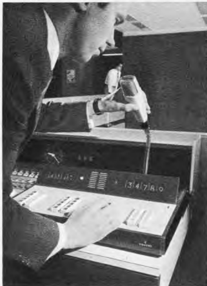
Bedienungspult für die Abgabe des Selektivruf-Codes mit Zusatzinformation nach vorheriger Überprüfung in einer Küstenfunkstation. Diese Anlagen werden im Herbst bei Norddeich-Radio, Elbe-Weser-Radio und Kiel-Radio eingebaut sein
