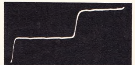
Bild 3b. Oszillogramm bei Unterbrechung einer 60-Ω-Hf-Leitung
