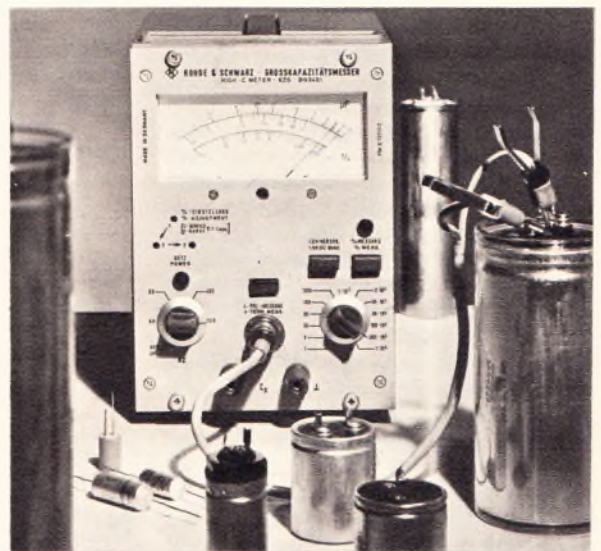
Bei dem Großkapazitätsmesser KZG von Rohde & Schwarz beträgt der Meßfehler maximal 2% vom Endwert
