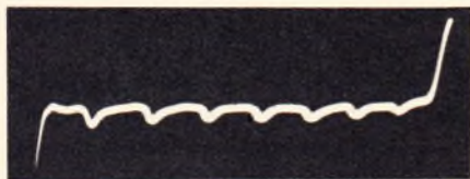
Bild 5a. Stammleitung einer Gemeinschaftsantennen-Anlage mit acht Steckdosen. Der Impedanzanstieg am Ende zeigt, daß sich in der Enddose ein 70- \Omega -Abschlußwiderstand befindet. Zusammen mit der Belastung durch das Anschlußkabel ergibt sich dann ein Gesamtwiderstand von 60 \Omega . Y-Verstärkung \times 1
