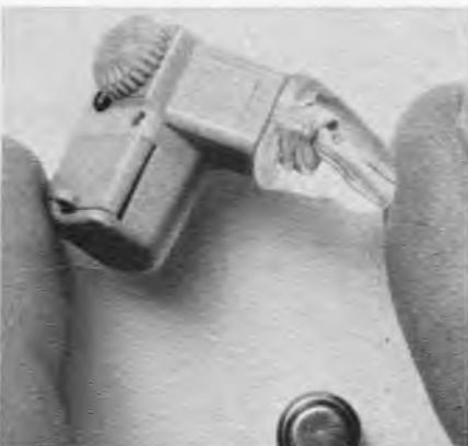
Bild 11. Im-Ohr-Hörgerät (IdO) von Philips für leichte bis mittlere Schwerhörigkeit. Das abschraubbare Ohrstück wird zweckmäßig individuell geformt und angepaßt, darunter die kleine Batteriezelle
