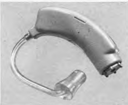
Bild 9. HdO-Gerät mit Ohrolive. Bei diesem Modell (Willco-Attache) befindet sich das Mikrofon am entgegengesetzten Ende wie der Hörschlauch
