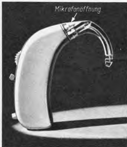
Links: Bild 8 Hinterdem-Ohr-Hörgerät (HdO). Die Mikrofonöffnung sitzt oberhalb des vom Hörer kommenden Schlauches (Robert Bosch Elektronik)
