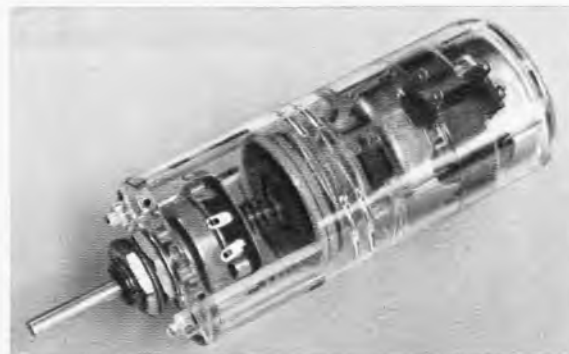
Bild 1. Ruwido-Motor-Drehwiderstand Typ 2002 für Fernbedienungen von Rundfunk- und Fernsehgeräten. Der Motor rechts treibt über ein Zahnradgetriebe und eine Rutschkupplung das Potentiometer links an
