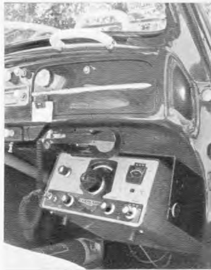
Bild 1. Bei dieser Einbauart bildet sich zwischen Transceiver und Armaturenbrett ein Warmluftpolster
