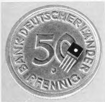
Links: Bild 23. So klein im Verhältnis zu einem 50-Pfennig-Stück ist der integrierte Mikrobaustein OM 200 von Valvo (Aufnahme: D. Limann)
