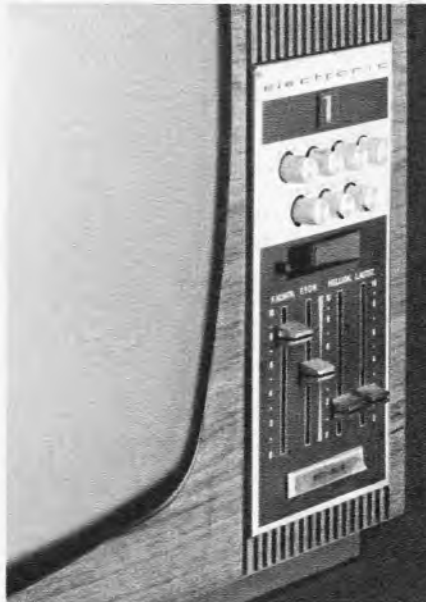
Bild 6. Abstimmteil der Grundig-Farbfernsehgeräte mit sieben Stationstasten und Schiebepotentiometern sowie Leuchtzifferanzeige des gewählten Programms
