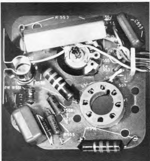
Bild 10. Bildröhrenplatine im Chassis F 209 von AEG-Telefunken mit Video-Endstufe (Transistoren im Kühlblech)
