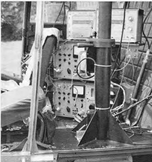
Bild 5. Geräteausrüstung des Hubschraubers, Teleskopmast mit Meßantenne
