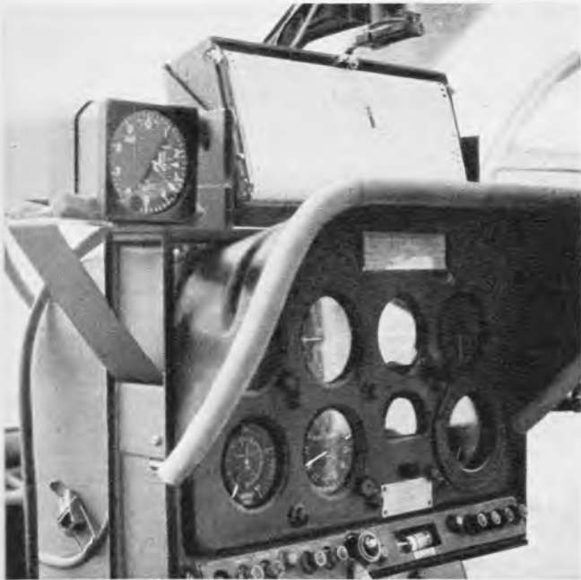
Bild 7. Der Flugwegschreiber. Sein Schreibstift bewegt sich in X-Richtung die Karte in Y-Richtung
