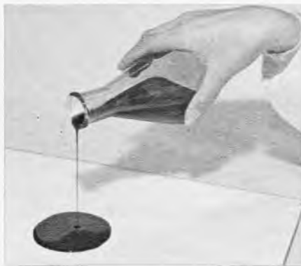
Bild 1. Auftragen des flüssigen Fotoleiters auf den Träger
