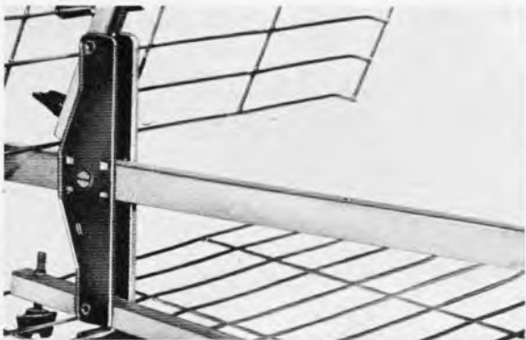
2. Reflektorhälften hochklappen und mit Flügelschrauben festziehen.
