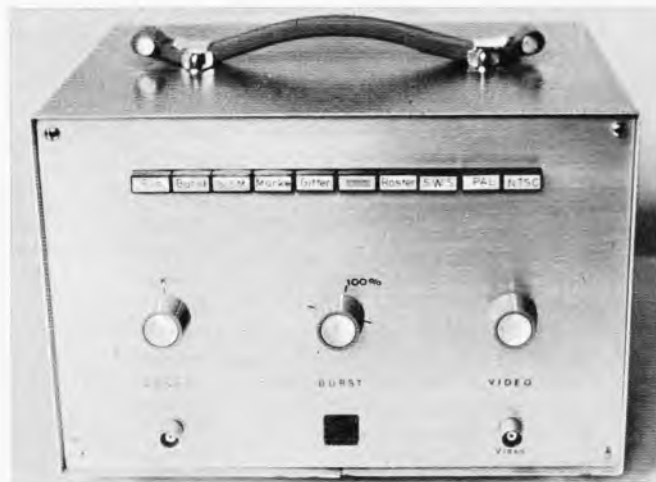
Rechts: Bild 1. Außenansicht des Regenbogengenerators (Aufnahmen: Ehlen)
