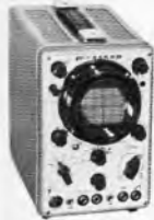
CTR-NF-Generator SWG 26 Frequ.-Ber.: 20 Hz bis 200 kHz bei Sinus und 20 Hz-150 kHz, Rechteck max. 7 V, Ausgangsimp. 1 k \Omega . Mit Meßschnüren 150,-
