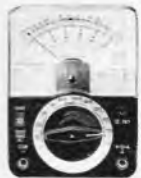
HANSEN Unitester m. Überlastungsschutz HM 15, mit Spiegelskala, Innenwiderst. 10 k \Omega/V , DC: 0-7-35-140-350-700 V, 0-100 \mu A, 0-1,4-140 mA, AC: 0-7-35-140-350-700 V, 0-200 \mu A, R: 0-50 k \Omega , 0-5 M \Omega , Kap.: 100 pF-1 \mu F, Indukt.: 0-1000 H, dB: -15 bis +59, Maße: 160 x 100 x 45 mm, Gew.: 500 g, mit 2 Prüfschnüren, 1 HV-Tastkopf 17,5 V, 1 HF-Tastkopf und Batterie 91,-
