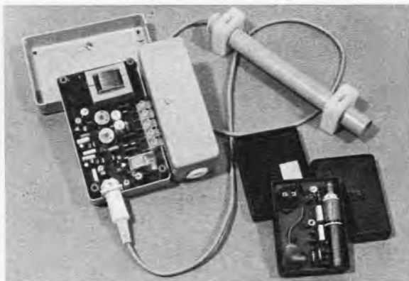
Bild 4. Eine vollständige Anlage (H. Wilkens, Hamburg) besteht aus dem Empfänger mit aufgestecktem Netzanschlußkasten (links), der abgesetzten Antenne (oben rechts) und dem Taschensender (Aufnahme: Leutmayr)
