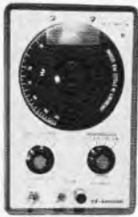
CTR-NF-Generator SWG 26 Frequ.-Ber.: 20 Hz bis 200 kHz bei Sinus und 20 Hz-150 kHz, Rechteck max. 7 V, Ausgangsimp. 1 k \Omega . Mit Meßschnüren 150,-
