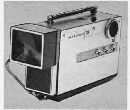
Bild 2. Kleinstfernsehgerät für VHF und UHF, Modell TR-001, mit abnehmbarer Vergrößerungslinse vor dem sehr kleinen Bildschirm der 30°-Röhre
