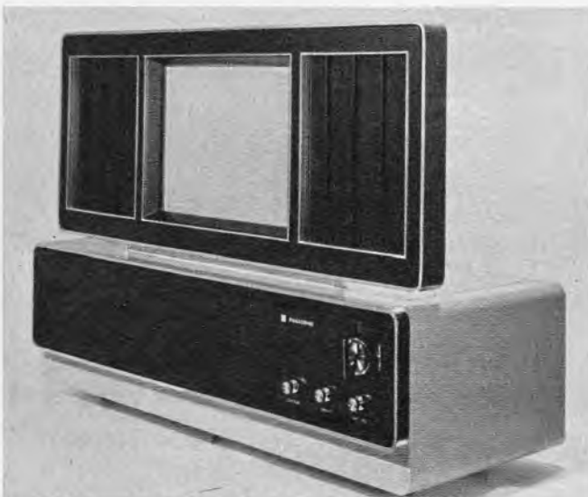
Bild 1. Laboratoriumsmuster eines Fernsehempfängers mit nur 2 cm tiefem Elektroluminiszenz-Bildschirm für ein 230-Zeilen-Bild
