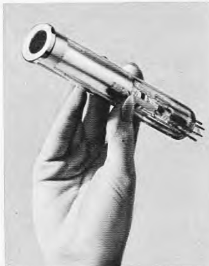
Bild 1. Extrem lichtempfindliche 1-Zoll-Bildaufnahmeröhre mit mehreren hunderttausend Fotodioden als Target (Modell C 23136 von RCA)
