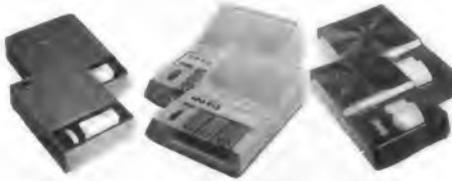
Trans.-Anlagen z. direkten Anschluß an die Steckdose ohne zusätzl. Drahtverlegung, Reichweite: mehrere hundert Meter. Die Funktion ist gewährleistet, wenn der Steckdosenkreis an die gleiche Phase angeschlossen ist. Die Anlagen bestehen aus 2 Geräten gleicher Bauart. Jedes Gerät m. Kontrolllampe z. Funktionsanzeige; Betriebsp. 220 V.
