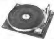
Einbau-Spielerchassis mit Stereo-Magnetsystem! Leichtmetallarm mit Ausgleichgewicht u. geeichtem Einstellring 0-8 p. Antiskating, Tonarmlift, schwerer Plattenteller 280  $\phi$  x 25 mm hoch, ca. 2,1 kg, mitlaufende Mittelachse, Rumpeln - 35 dB, Wow 0,2  $\frac{1}{2}$ %, Flutter 0,06  $\frac{1}{2}$ %, Synchronmotor 220 V/50 Hz. Maße: 334 x 286 mm, unter Werkboden 62 mm, über Werkboden 73 mm, ohne System ..... **DM 129.-**
