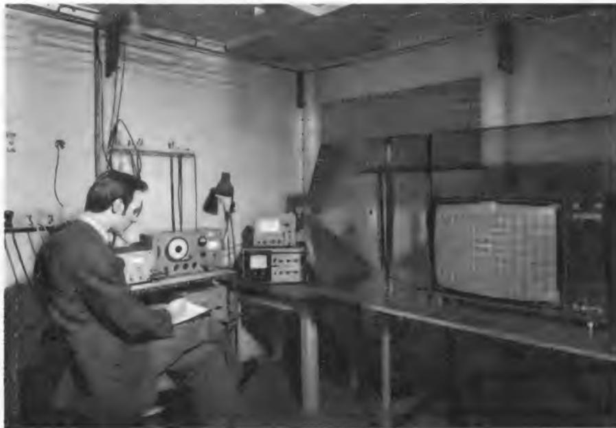
Das ist „Jacky“, ein Gerät das im Philips-Werk Krefeld benutzt wird, um die Einstrahlungsfestigkeit von Geräten der Unterhaltungselektronik zu testen
