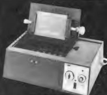
Ein leistungsfähiges Gerät aus dickwandigem PVC. Metallteile aus Titan. Druckluftzufuhr über Kompressor max. 3 atü. Regelbare Titanheizung. PVC-Plattenhalterung. Abm. 725 x 480 x 210 mm.
