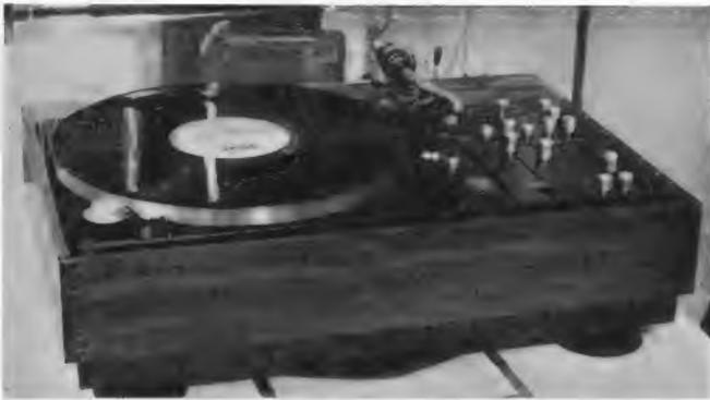
Plattenspieler-Verstärker „Fonomaster“, ausgelegt für 18<sup>1</sup>/<sub>2</sub>, 33<sup>1</sup>/<sub>2</sub>, 45 und 78 U/min, Stereoverstärker 2 × 15 W, Klirrfaktor < 1 ‰. Dieses Gerät wird in der Regel mit zwei Lautsprecherboxen geliefert
