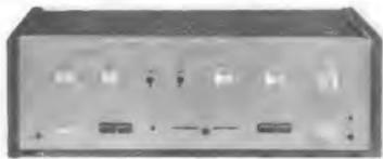
**Monacor SA 800.** Professioneller Leistungsverstärker für universelle Einsatzmöglichkeiten. 7 Eingänge, 2 Ausgänge, Lautsprecher-Gruppenschalter, Mikrofonmischregler, 2x 90 W Musikleistung, Klirrfaktor 0,1 %. Best.: 25 Trans., 3 IC, 7 Dioden. **DM 598.--**
