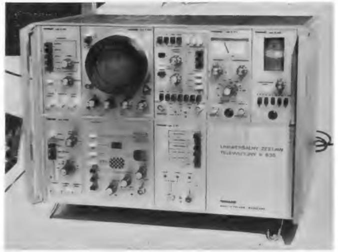
Universal-Fernsehprüfgerät K 935 in Einschubtechnik für SW- und Farbfernsehempfänger. Eingebaut sind ein Oszillograf, je ein Wobbelsender für Bereich I–III und IV–V, Markengeber, Generatoren für Bereich I–III und IV–V, FM-Modulator und BAS-Generator oder wahlweise Farbgenerator E 420
