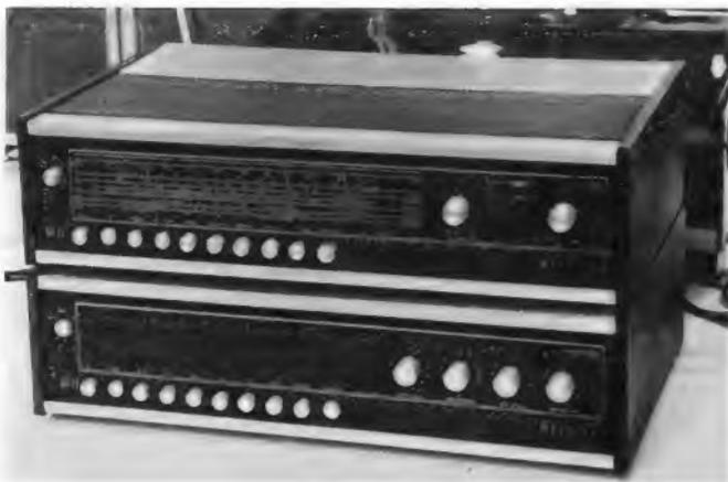
Stereo-Tuner-Verstärker „Meluzyna“ der Diora-Werke, ein Gerät der Klasse 1. Der Tuner empfängt LW, MW (unterteilt in zwei Bereiche), 3 x KW und UKW. Die Ausgangsleistung wird mit „2 x 30 VA“ angegeben
