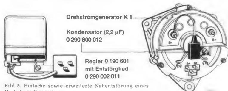
Bild 5. Einfache sowie erweiterte Nahentstörung eines Drehstrom-Generators der Type K sowie eines mechanischen Reglers
