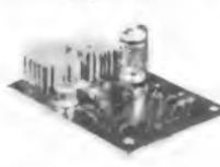
**4-W-NF-Verstärker Typ 4/12.** Kleinverstärker auf gedruckter Platine mit überdimensionierten Kühlkörpern. Frequenzbereich 35 Hz bis 18 000 Hz, Impedanz 4  $\Omega$ , Klirrfaktor 1 %, Stromversorgung 12 V, Eingangsspannung 35 mV, Störspannungsabstand 80 dB. Maße: 65 x 50 mm.
