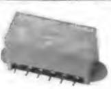
**Lichtorgel-Module.** Vollwellensteuerung mit Triac, steckbar, Leistung 1000 W. Aussteuerung über Lautsprecherausgang eines Verstärkers. Für 3 verschiedene Frequenzbereiche lieferbar. Durch Zusammenschalten der drei Module ergibt sich eine leistungsstarke, komplette Drei-Kanal-Lichtorgel. Keine Frequenzweiche notwendig.
