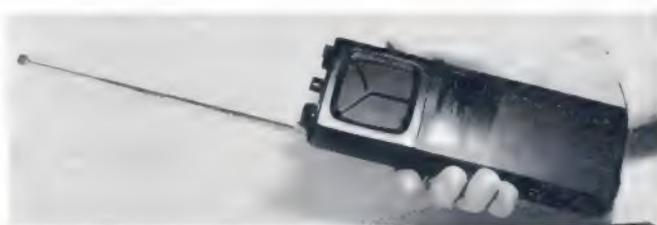
Bild 6. Das Handgerät SR-C 146 A, mit dem man über Relaisstellen mit nur 2 W Weitverkehr abwickeln kann
