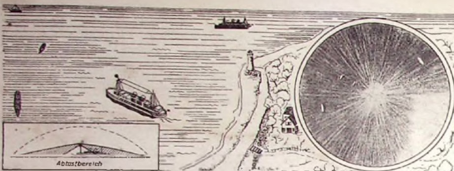
Abb. 2. Bildanzeige eines Rundsuchgerätes für den Seeverkehr. Die Lichtflecke geben andere Seefahrzeuge und die Küstenlinie lagerichtig wieder. Ihr Abstand vom Bildmittelpunkt ist ein Maß für die Entfernung der Hindernisse
