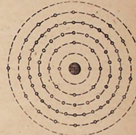
Abb. 3. Elektronen-Konfiguration eines schweren Atoms mit sechs Schalen (Quecksilber). Die Elektronenverteilung ist von innen nach außen: 2, 8, 18, 32, 18, 8.
