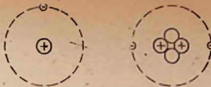
Abb. 1. Links: Aufbau eines Wasserstoffatoms, bestehend aus 1 Proton als Kern und 1 Elektron in der ersten Elektronenschale. Rechts: Heliumatom, bestehend aus 2 Protonen und 2 Neutronen im Kern sowie 2 Elektronen in der ersten Schale.
