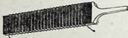
Abb. 2. Beispiel der Anwendung einer hochfrequenten Induktionsheizung zur Oberflächenhärtung von Feilen (Schematische Darstellung)
