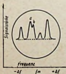
Abb. 1. Ein Kurvenzug der Abstimmung von dem Schirm der Braunschens Röhre. Rechts Abb. 2. Die grundsätzliche Schaltung des Gerätes, das an jedem Kurzwellensuperhet hier anzuschließen ist.
