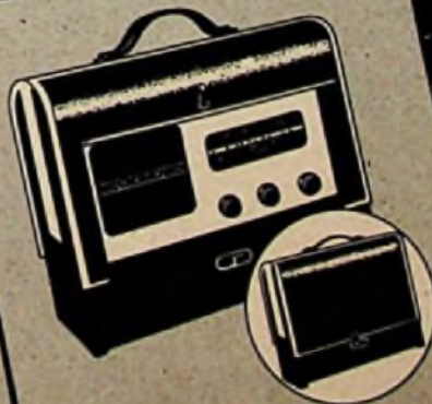
Fada P83 5-Röhren-Superhet, Koffergerät in Aktentaschenform, Kunstleder- bezogenes Holzgehäuse
