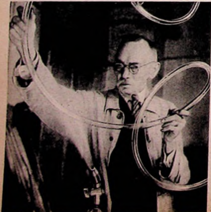
worauf das Anschmelzen des anderen Endes des Elektrodenrohrs an die Vakuumanlage zwecks Vorpumpens erfolgt
