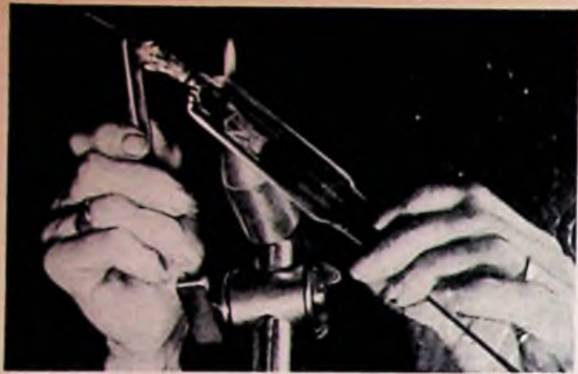
Die Herstellung der Leuchtröhren beginnt mit dem Einsetzen der Elektroden (mit Quetschfuß und Zuleitung) in ein kurzes Glasrohr.
