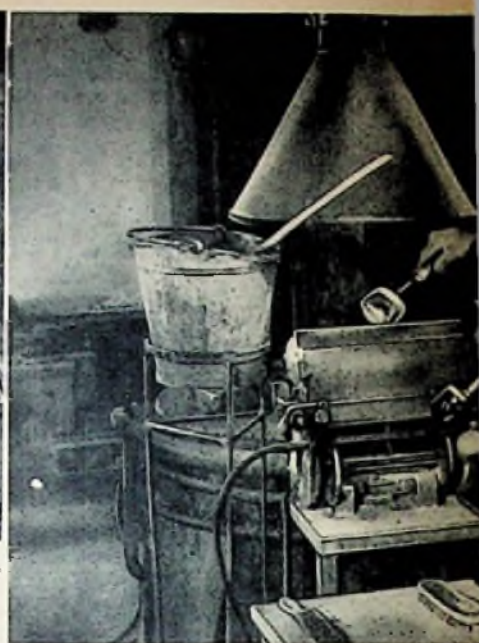
Abb. 2. Das Gießen der Hartbleibarren, das Rohmaterial für die Gitterplatten
