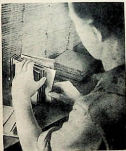
Abb. 10. Einfügen der Plattenscheider
