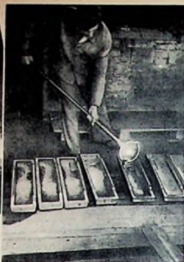
Abb. 2. Das Gießen der Hartbleibarren, das Rohmaterial für die Gitterplatten
