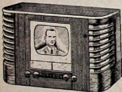
Abb. 2. Fernseh-Tischempfänger BT 7092 der General Electric Co., zusammgebaut mit Rundfunksuperhet. Skala des Rundfunkteiles unter dem Bildschirm, darunter Bedienknöpfe und Senderwahlkasten. Beachtenswert ist die seitliche Anordnung der Lautsprecheröffnungen
