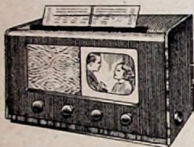
Abb. 1. Fernseh-Tischempfänger 563A der Philips Electrical Ltd. in Vereinigung mit Rundfunksuperhet. Bildschirm und Lautsprecher nebeneinander, Abstimmkala auf freistehender Glasscheibe über dem Gehäuse Zeichnungen: Trester
