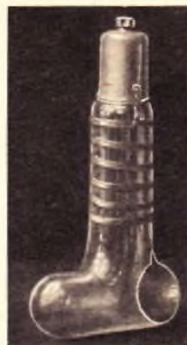
Abb. 9. Anlaßband am Oberarm eines Glasgleichrichters
