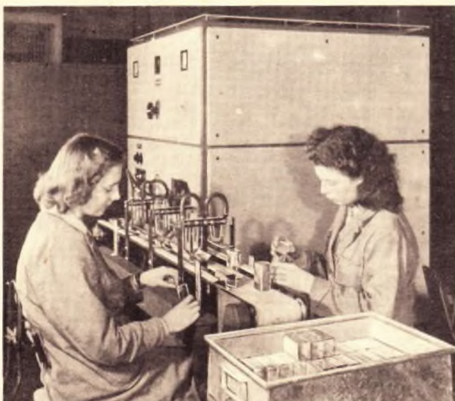
Abb. 1. Hochfrequenz-Induktionsofen, Bauart Philips. Löten von Kondensator Dosen mittels HF-Induktionsheizung. Werkfotos: Philips
