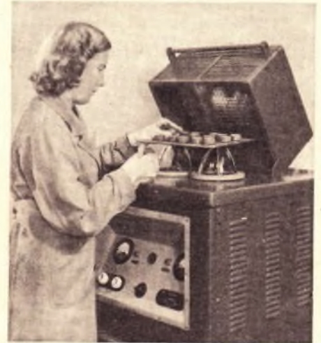
Abb. 2. Vorwärmen von Kunstharzpillen im Dielektrikofen. Die auf Glasisolatoren sichtbare Platte bildet die eine, die Schutzhaube die andere Kondensatorseite
