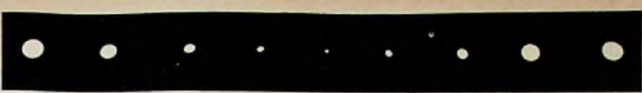
Abb. 7. Leuchtfleckbilder bei verschiedenen Spannungen an der Hilfsanode a_2
