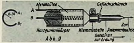
Abb. 9. Schnitt durch eine Tastenleiste zum Aufsuchen von Gehäuseundichtigkeiten bei Hörsfrequenzen. Ausführung B zum direkten Aufsetzen, wenn spannungsfreie Gehäuse vorliegen, anderenfalls ersetzt man zweckmäßig die Spitzen durch eine Drahtschleife Al-Bi- (Fig. A)
