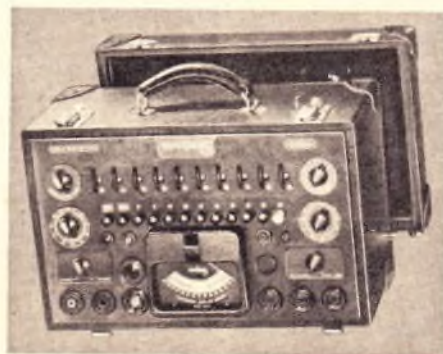
Modell 335 ein hochwertiges Röhrenprüfgerät aus den USA.
