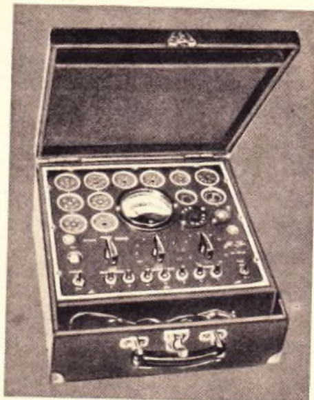
Schweizer Röhrenprüfgerät Preciso, ein einfacher Leistungsmesser
