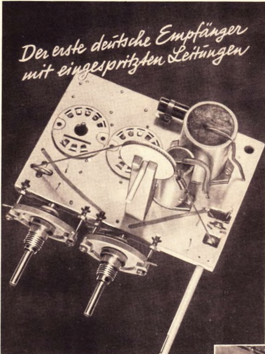
Ansicht des fertig geschalteten Chassis, bereit zum Einbau.
