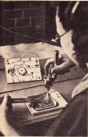
Die Silberlösung wird mit Hilfe von Leitungsschablonen auf die Grundplatte aufgespritzt
