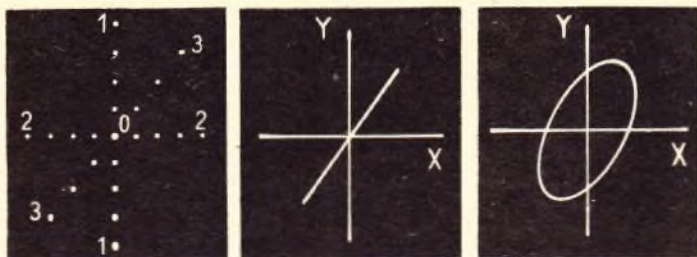
Abb. 13a (links): Leuchtfleckablenkung durch Gleichspannung an den Plattenpaaren; a) Schirmbild, 1. Gleichspannung nur an den Y-Platten, 2. Gleichspannung nur an den X-Platten, 3. Gleichspannung gleichzeitig an den X- und Y-Platten
