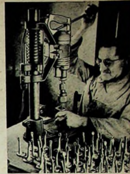
Rechts: Bohren der Schraublöcher für die Antennenhalter
