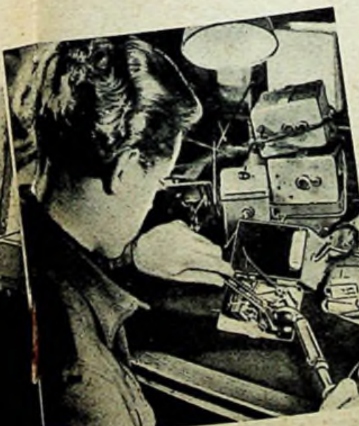
Montage von Mikروفonverstärkern für Rufanlagen zum Selbstbau Links: Aus verschiedenem Altmaterial entstehen neue Radiogehäuse Rechts: Beratung des Kunden ist eine der wichtigsten und vornehmsten Aufgaben des Radiohandels
