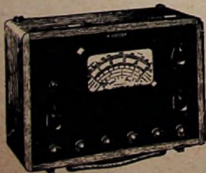
Abb. 1. Universalinstrument mit 90 Meßbereichen der Taylor El. Instr. Lt., Slough (England)
