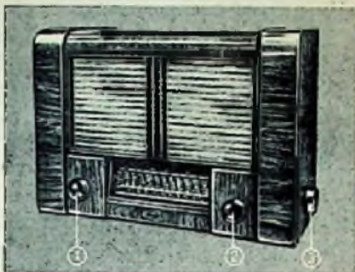
1. Lautstärkereger mit Netzschalter, 2. Sender-einstellung, 3. Wellenbereichschalter
