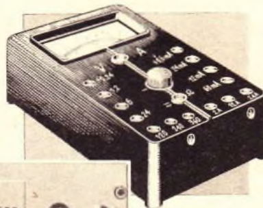
Das Siemens-Vielfachinstrument ist für Gleich- und Wechselstrommessungen bestimmt, die Umschaltung auf die verschiedenen Strom- und Spannungsmeßbereiche erfolgt mit einem Sicherheitsstecker
