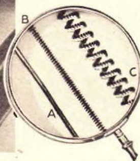
Abb. 2. A ein Menschenhaar, B ein einzelner Spiralfaden und C ein doppelt gewendelter Glühfaden in richtigem Größenverhältnis
