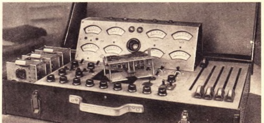
Der Telefunken-25-W-Verstärker „Elo V 25/0210“ arbeitet mit zwei Vorverstärkerstufen und einer Gegentaktendstufe und ist mit den Röhren EF 12 k, 2xEF 12, 2xEL 12 und AZ 12 bestückt.
