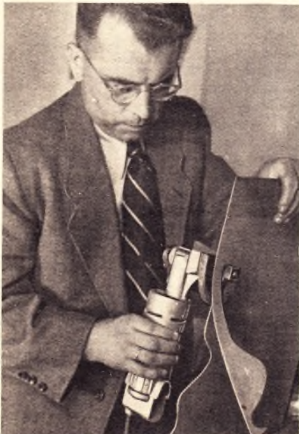
Elektro - Blechhandschere der Firma Trumpf & Co., vorm. Julius Geiger, Stuttgart, mit einer Schnittgeschwindigkeit von 2,5 m/min
