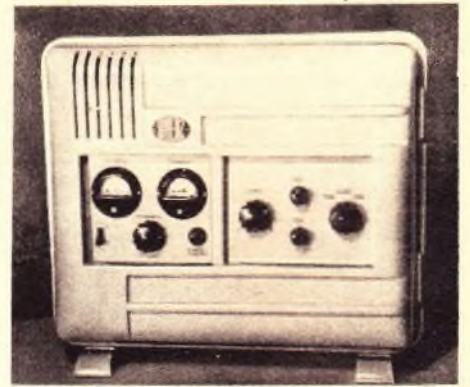
20-W-Verstärker der C. Lorenz AG. in Metallgehäuse, der mit den amerikanischen Röhren 3x6 SJ 7, 2x6 L 6 und 1x5 U 4 bestückt ist
