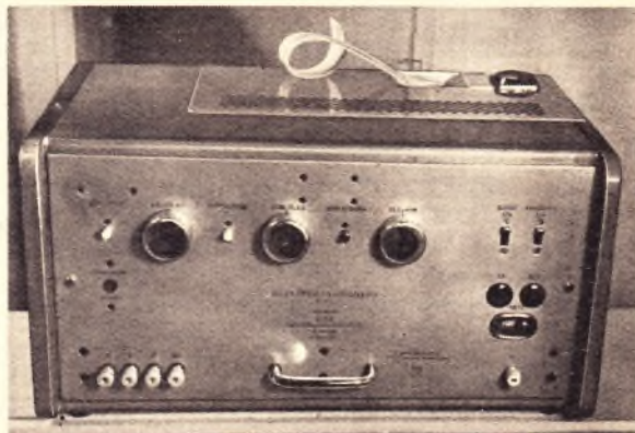
Universal-Strahlenmeßgerät der Anders & Co. KG., Gauting bei München, zur quantitativen und qualitativen Messung von Korpuskular- und Wellenstrahlung nach dem Zählrohrverfahren
