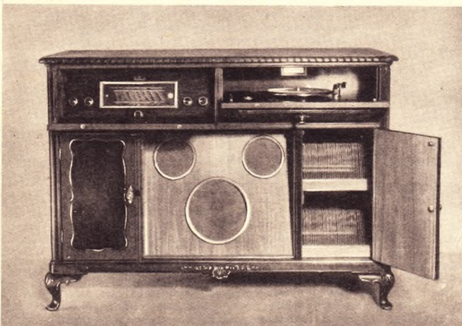
Der Groß-Musikschrank „Titan 2“ von Waldschmidt, Mehly b. Kappeln/Schlei, enthält einen Sechskreis-Super und einen Dreikanalverstärker mit 13 W Sprechleistung, drei Lautsprecher u. zw. ein Hochtonsystem, ein Mittel- und ein Tiefton-Chassis, Plattenspieler, ein Magazin für 120 Platten
