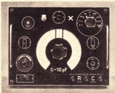
Die RC-Meßbrücke von Franz Maria Heidecker, Berlin-Spandau, ermöglicht Widerstands-, Kapazitäts-, Induktivitäts- und Prozentmessungen
