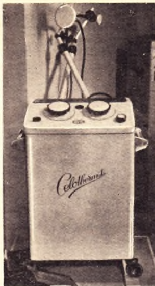
UKW-Therapiegerät „Celotherm I“ für 300 W Leistung der C. Lorenz AG.
