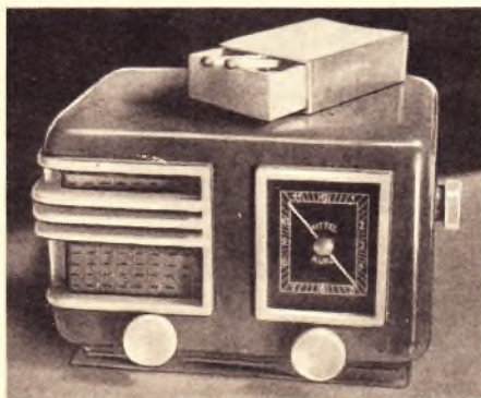
Allstrom-Einkreiser „DWARF“, der z. Z. kleinste Empfänger, von der Fa. Rundfunkgerätebau Niedersachsen, Bernhard Wobbe, Winsen a. d. Luhe
