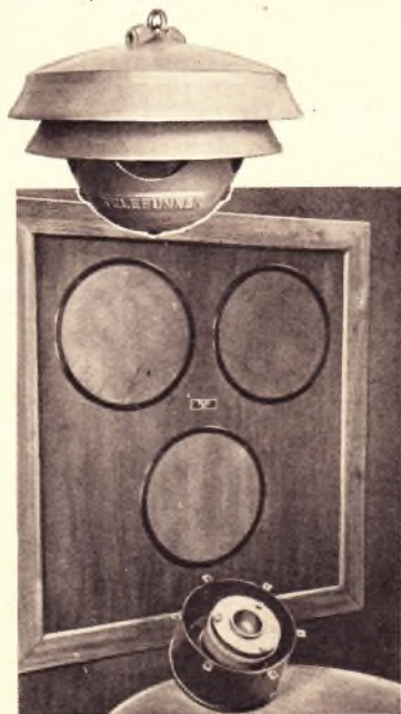
Rechts oben: Schallinglautsprecher „Ela L 0710“ mit einer Gesamtbelastung von 30 W, die von den eingebauten 5 parallel geschalteten perm.-dyn. 6 W-Chassis geliefert werden. Rechts: Drei-Lautsprecher-Kombination und (darunter) der neue Hochtonlautsprecher mit schwenkbarem System zur Einstellung der Abstrahlrichtung
