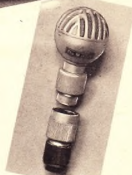
Der Hagenuk-Kissen-Lautsprecher. Rechts: Das Telefunken-Mikrofon „Ela M 0300“ mit Seignettesalz-Kristallelement überträgt ein Frequenzband von 50 ... 10 000 Hz bei einer Anhebung von 10 db bei 10 000 Hz
