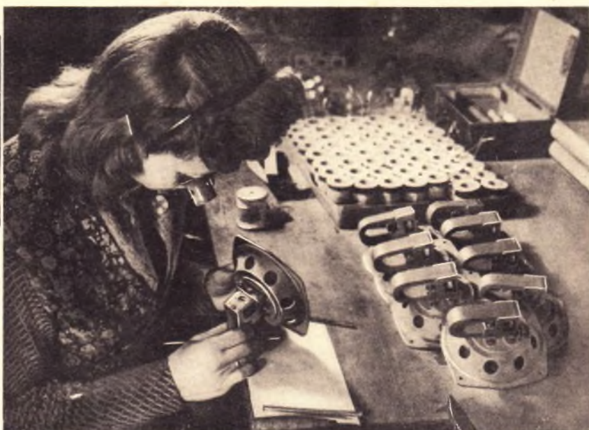
Justieren des Systems und Lupenprüfung des Lautsprechers auf Sauberkeit
