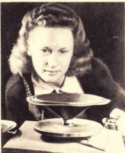
Kontrolle des Schlagens des Membranrandes mit Hilfe eines Plattenspieler
