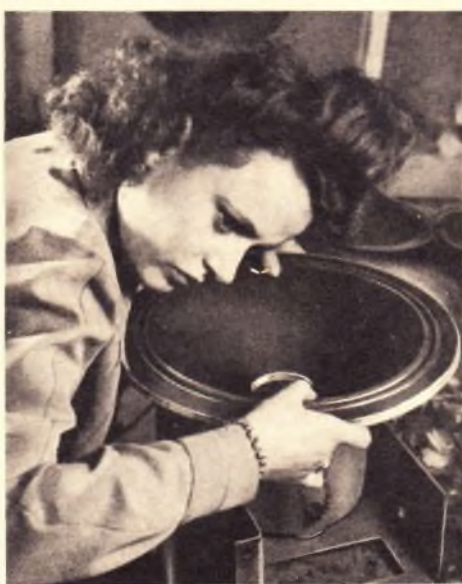
Kratzgeräusche werden mechanisch-akustisch festgestellt
