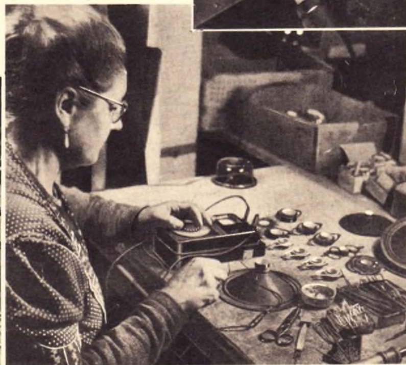
Unten: Elektrische Prüfung von Schwingspulen
