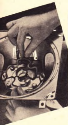
Die Zentrierspinne wird vorher als Einzelstück angefertigt
