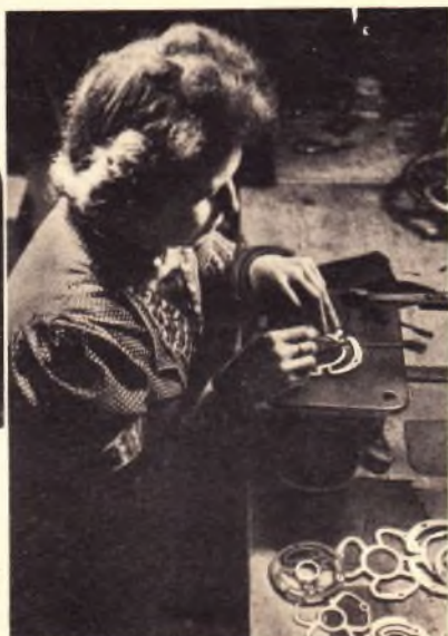
Die Zentrierspinne wird vorher als Einzelstück angefertigt
