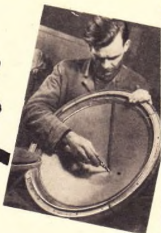
Einschrauben einer großen geklebten Membran
