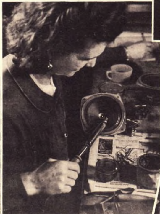
Einsetzen der Membran beim Frischwinger (links). Anschließend erfolgt die Verlötlung des Membranhütchens mit dem Steckstift
