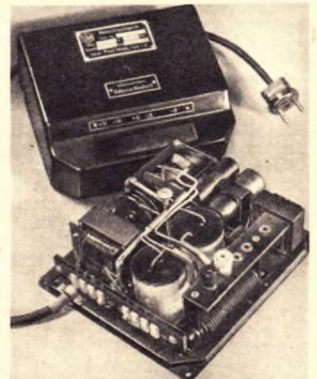
Abb. 4. Das Netzvorsatzgerät und sein Gehäuse. Links vorn die Umschaltleiste für die Heizstrom-einstellung, dahinter nach rechts oben Netztransformator, Heizgleichrichter und Heizdrossel. Im Vordergrund die Anschlussleiste für Heiz-, Anoden- und Gitterspannung, darunter die Anodenspannungsgleichrichter, daneben die Anodensiebkondensatoren. Aufnahme: Stumpf
