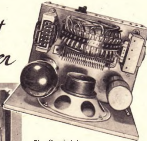
Die Chassis-Aufsicht läßt die Anordnung der Einzelteile erkennen
