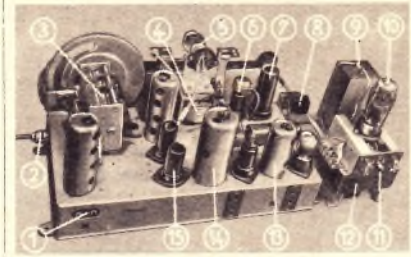
1. Antennen-Erdanschluß, 2. Wellenschalter, 3. Dreifach-Drehkondensator, 4. Ausgangstrans- formator, 5. Magisches Auge 6 E 5, 6. NF-Vor- verstärker 6 K 7, 7. Endröhre 6 L 6, 8. Lautstär- kerregler mit Netzschalter, 9. Siebkondensator, 10. Netzgleichrichter 5 Z 4, 11. Netzspannungs- wähler mit Sicherungshalter, 12. Netztransfor- mator, 13. Zweikreis-Bandfilter, 14. Dreikreis- Bandfilter, 15. Mischröhre 6 SA 7
