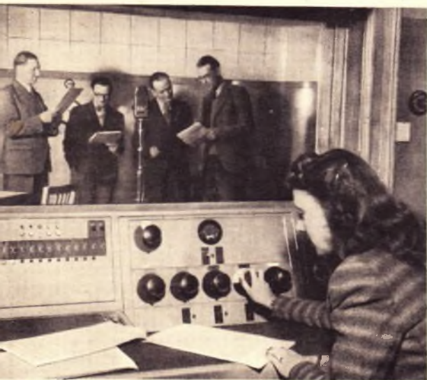
Blick durch das schalldichte Fenster vom Kontrollraum des Toningenieurs in das Studio 4A. Links: das Kontrollpult des Tonteiles des Fernsehsenders, der auf einer Frequenz von 41,5 MHz (7,23 m) arbeitet. Im Bild rechts: Sender und Modulator. In der Mitte: HF- und Kristallsteuerstufe. Im Bild links: die Geräte zur Stromversorgung des Senders
