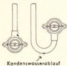
Abb. 8. Falsche (links) und richtige (rechts) Schaltereinführung bei Stahlpenzrohr im Freien und in feuchten Räumen. Das Rohr muß im Bogen geführt und im tiefsten Punkt mit einem Loch zum Ablauf des Kondenswassers versehen werden
