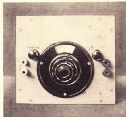
Abb. 2. Die Deckplatte des Geräts, an deren Unterseite alle Einzelteile befestigt sind
