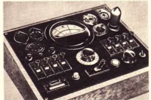
Aufsicht auf das Röhrenprüfgerät „Exakt“ Type K Rückansicht des Röhrenprüfgerätes „Exakt“ Type K ohne Heiztransformator
