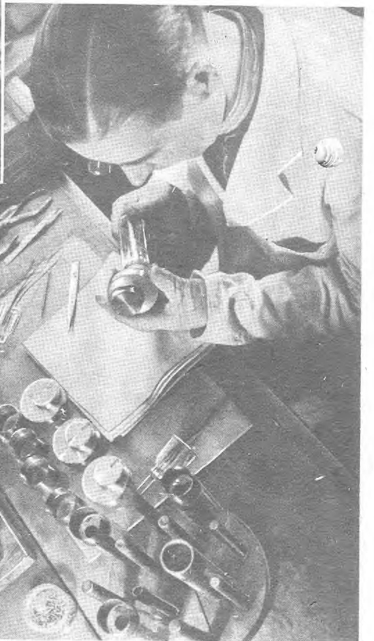
Vier kleine Röntgenröhren im Hochvakuum-pumpenstand. Unten: Glühkatoden für Diagnostik-Röhren erfordern beim Aufbau höchste Präzision
