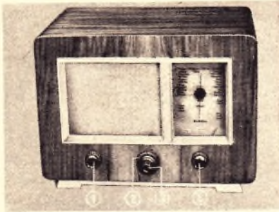
1. Lautstärkereger, 2. Abstimmung normal, 3. Abstimmung fein (f.KW), 4. Wellenschalter
